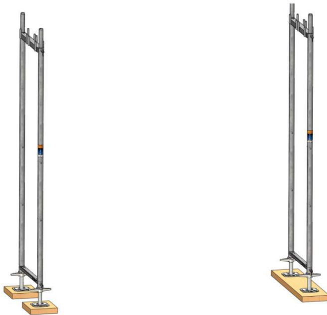
Bild 6: Aufbau des ersten Gerüstfeldes: Vertikalrahmen
