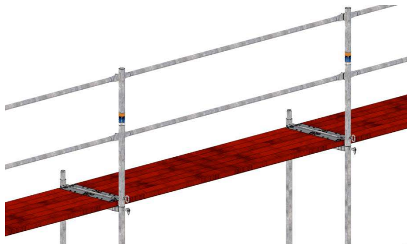
Bild 44: Oberer Abschluss mit Geländerpfosten mit Traversen.
