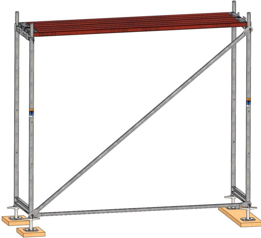
Bild 16: Fertig montiertes erstes Gerüstfeld
