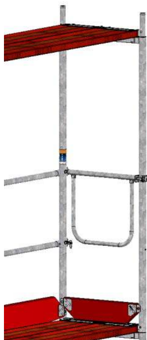
Bild 33: Stirngeländer montiert, offenes Rohrende auf einen Kippstift aufgesteckt.
