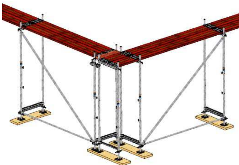
Bild 19: Eckausbildung mit drei Vertikalrahmen
