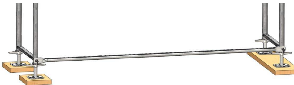
Bild 7: Aufbau des ersten Gerüstfeldes: Längsriegel
