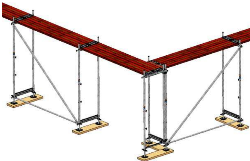
Bild 18: Eckausbildung mit zwei Vertikalrahmen
