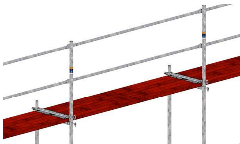
Bild 45: Oberer Abschluss mit Geländerpfosten und Belagsicherungen.
