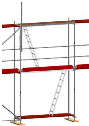
Bild 26: Montage des ersten MSG-Pfostens.
