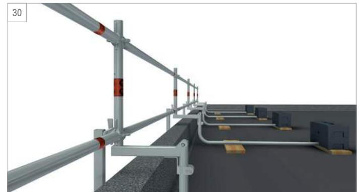
Bei Flachdachausführungen ohne Brüstung oder Attika müssen gleichwertige Maßnahmen ergriffen werden (z. B. Anschläge am Rand des Daches) um ein Verschieben bzw. Verrutschen der Geländerpfosten zu verhindern.
