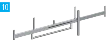
9 1214.180 Fahr balkon 1,80 m Stahl-Rechteckrohr, feuerverzinkt. Zur Basisverbreiterung für fahrbare Arbeitsbühnen. Breite 1,80 m, Gew. 14,4 kg.
