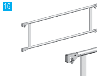
17 1207.180 Träger 1,80 m aus Aluminium. Trageelemente im Gerüstbaukasten oder doppelter Seitenschutz. Länge 1,80 m, Höhe 0,50 m, Gew. 7,2 kg.
