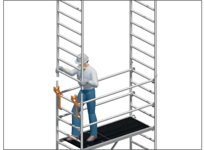
3. Diagonalen und Durchstiegsbrücke einsetzen.
