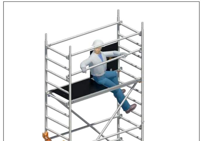
5. Innenseitiger Aufstieg über die Sprossen der Standleiter durch die dafür vorgesehene Durchstiegsklappe. In der Durchstiegsöffnung sitzend, absturzesichert durch die Holme der Durchstiegsbrücke 26, erfolgt die Montage des Zwischengländers der nächsten Lage, hierzu werden die Geländer 18 an den zweiten Sprossen über der Standfläche montiert.
