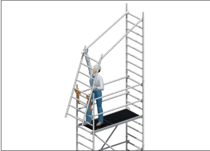
7. Einseitiges Aushängen der Geländer 18 aus der positionierten Standleiter.
