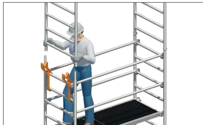
4. Durchstiegsbrücke 26 und Diagonalen 21 demontieren.
