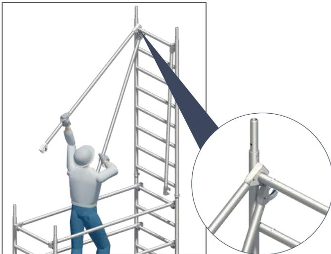
8. Demontage der Geländer 18 durch öffnen der Einrastklaue mithilfe von einem der unter 3. demontierten Zwischengeländer. Das lose Geländer 18 wird auf die 2. Sprosse von oben aufgelegt und wirkt als Hebel zum Öffnen des Schließbügels der Einrastklaue (siehe Detail).
