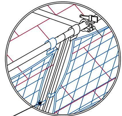
Die Stöße zweier Schutzwandrahmen müssen grundsätzlich mit einem in die Netze eingearbeiteten Gurtschnellverschluss gesichert werden. Dazu muss dieser Schnellverschluss von dem eigentlichen Rahmen gelöst und um den benachbarten Rahmen geführt und wieder geschlossen werden.
