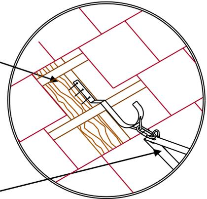
Jeder erste (je Absturzkante) zu montierende Netzschutzwandrahmen wird mit 2 Halterungen verankert (siehe Bild 1).
