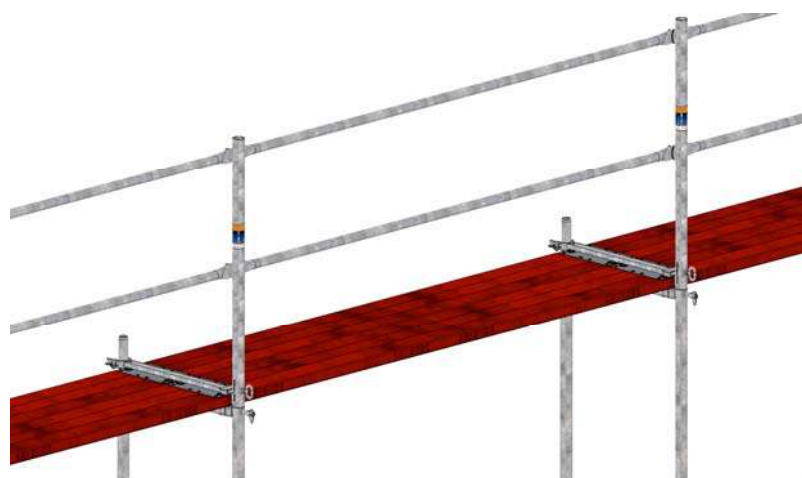
Bild 45: Oberer Abschluss mit Geländerpfosten und Belagsicherungen.
