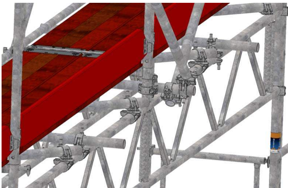
Bild 57: Anschluss der Diagonalen mit Normalkupplungen
