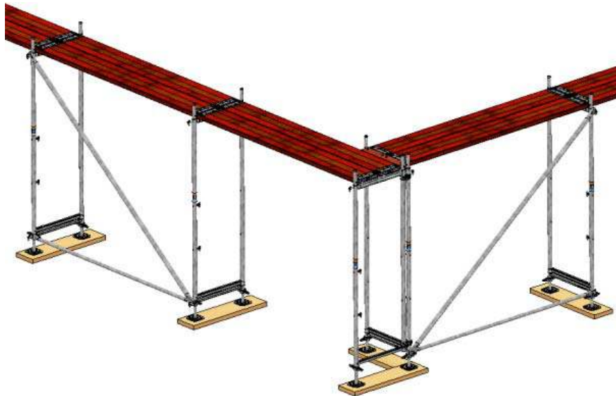
Bild 18: Eckausbildung mit zwei Vertikalrahmen
