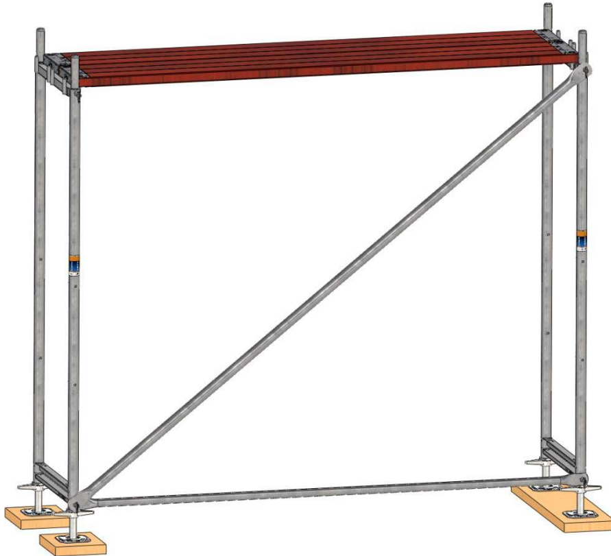
Bild 16: Fertig montiertes erstes Gerüstfeld
