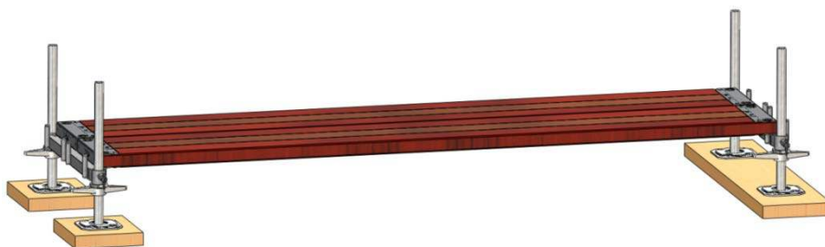
Bild 4: Systembeläge auf Belagtraversen
